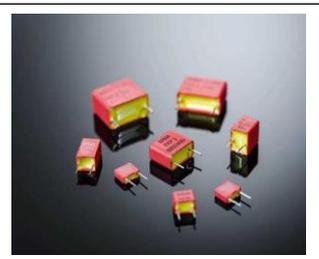
WIMA DC-Link Kondensatoren werden in Zwischenkreisanwendungen der Leistungselektronik, z. B. in der Umrichtertechnik eingesetzt, wo sie aufgrund steigender elektrischer Anforderungen in zunehmendem Maße die bisher verwendeten Elektrolyt-Kondensatoren verdrängen. Sie sind auf Basis einer verlustarmen Polypropylenfolie aufgebaut und weisen bei hohen Frequenzen eine höhere Wechselstrombelastbarkeit sowie eine niedrigere Verlustleistung/Eigenerwärmung auf als vergleichbare Elektrolyt-Kondensatoren.
